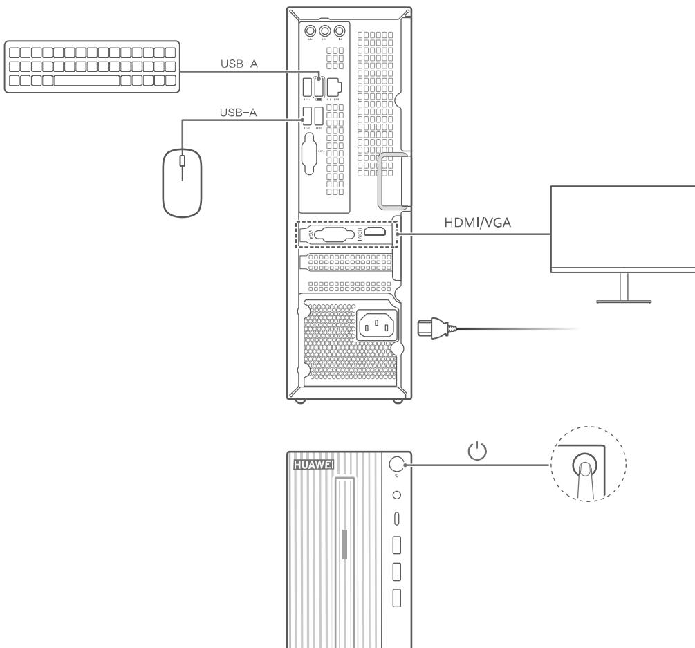
1. 完成显示器、鼠标、键盘、电源等连线后，短按电源键启动计算机。
